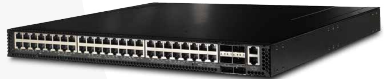
AS5712-54X/ AS5812-54T/ AS5812-54X 48 x 10GbE SFP+, 6 x 40GbE QSFP+
